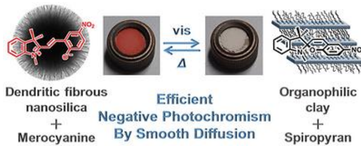
Figure II-6 : Photochromisme réversible d'une merocyanine rouge se transformant en spiroopyrane incolore par irradiation dans le visible [11].
