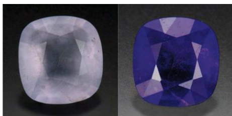
Figure II-4 : Coloration d'une pierre d'Hackmanite provenant de Birmanie avant (gauche) et après exposition (droite) à une irradiation UV de 365 nm [8].
