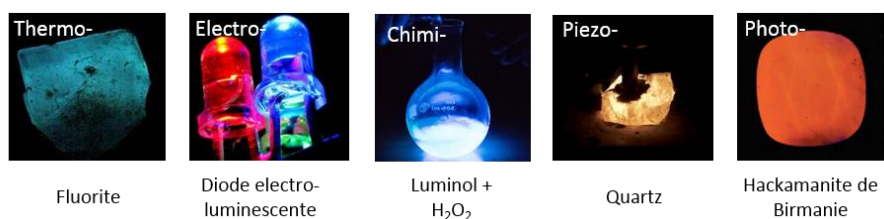
Figure I-3 : Illustration de matériaux luminescents selon la nature de la source excitatrice avec de gauche à droite : thermique, champs électrique, réaction chimique, pression ou photons.
