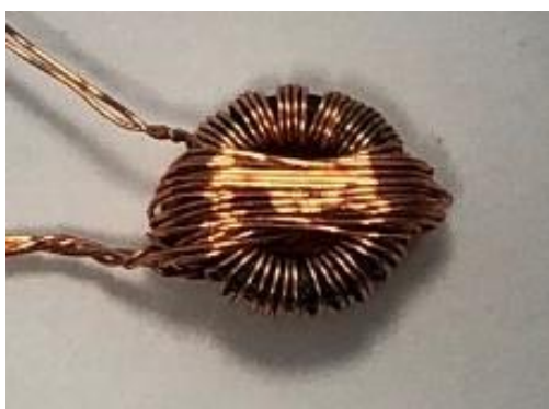
Figure 157: Bobine de mesure de 24 tours enroulée directement sur le noyau
