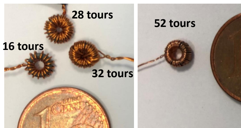
Figure 156: Divers noyaux magnétiques ayant une bobine d'excitation de 16, 28, 32 et 52 spires. La bobine 52 spires est faite avec du fil de diamètre 0.125mm, les autres avec du fil de 0.25mm de diamètre.
