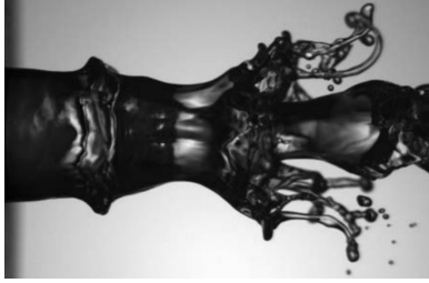
FIGURE I.4 – Formation de ligaments puis de gouttes   l'interface d'un jet liquide atomis  par un jet gaz co-axial (Marmottant & Villermaux [61]).
