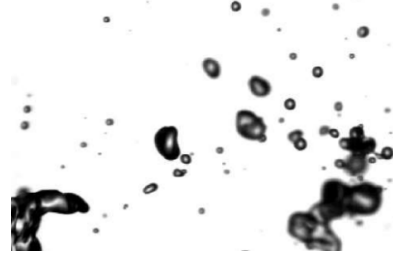
FIGURE I.4 – Formation de ligaments puis de gouttes   l'interface d'un jet liquide atomis  par un jet gaz co-axial (Marmottant & Villermaux [61]).
