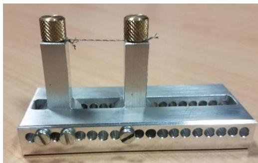
Figure II-3 : Support en acier pour l'observation des fils tendu par MEB
