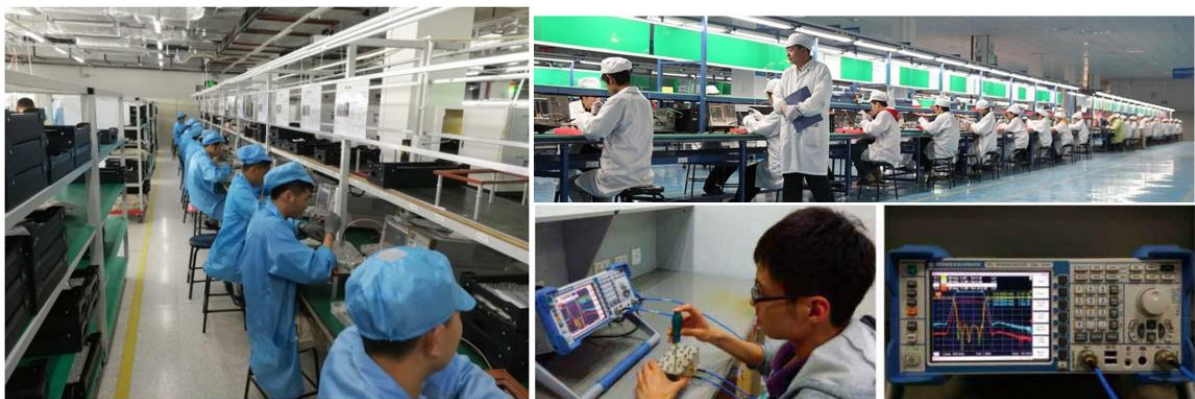
Figure 19: Réglage des filtres volumiques par des techniciens RF[32] [33] .
