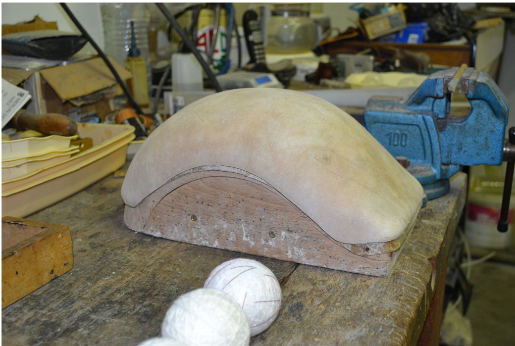
Fig. 65. La forme utilisée pour fabriquer les gants dans l'atelier Punpa.
