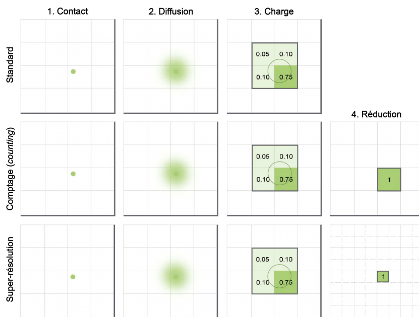
Figure 28. Les différents modes de détection d'électrons. Lorsqu'un électron entre en contact avec la caméra, son signal est diffusé et la charge accumulée divisée entre plusieurs pixels. En mode standard (ou d'intégration), les détecteurs ne suppriment pas le bruit engendré par la diffusion du signal. En mode comptage (ou counting ), la charge maximale est associée à un pixel. En mode super-résolution, la charge détectée est subdivisée par un facteur 4 dans l'exemple montré. Figure adaptée de https://www.gatan.com/improving-dqe-counting-and-super-resolution .
