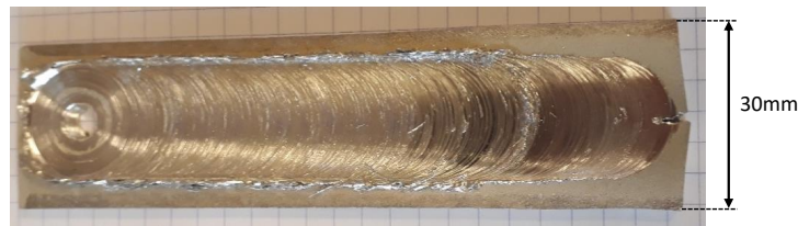
FIGURE 3.11 – Plaque de Mg-2%Ca exploitable après élaboration FSP, les conditions peuvent donc être retenues pour d’autres essais
