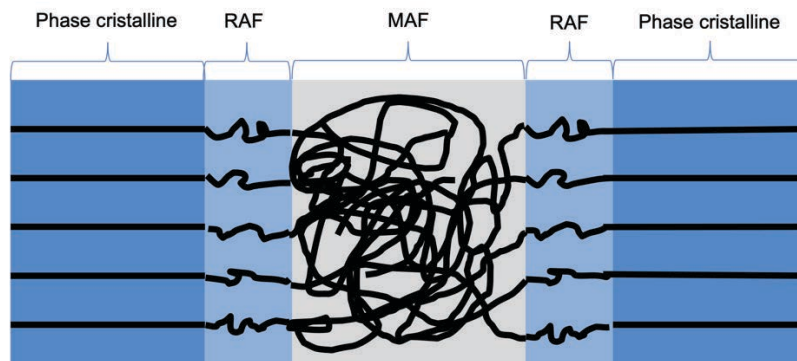
Figure I.B-10 — a) Schéma représentatif des différentes phases dans un polymère semi-cristallin selon le modèle à trois phases. RAF : fraction amorphe rigide, MAF : fraction amorphe mobile.
