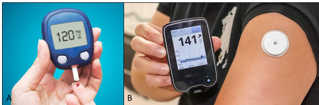
FIGURE 1.3 : A : Lecteur de glycémie. B : Capteur continu de glycémie (CGM).
