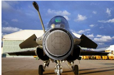
Figure 1: Avion RBE2 équipé d'un système RADAR AESA à balayage électronique
