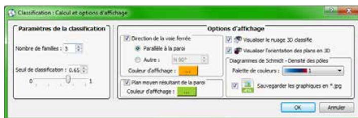
FIGURE B.3 – Gaia-GeoRoc : Menus et paramètres ajustables pour l'approche semi-automatique - (a.) Options de la classification du modèle pour l'identification des familles de discontinuités ; (b.) Options pour le calcul de l'espacement et/ou de l'extension pour une famille donnée.
