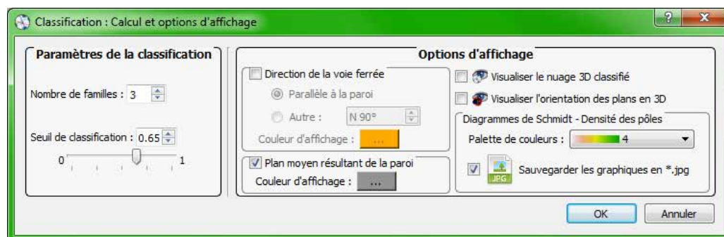
FIGURE IV-1.10 – Interface de paramétrage du calcul de classification et options d'affichage - Exemple standard de l'extraction de cinq familles. Les options graphiques sont accessibles via le cadre 'Options d'affichage'. Pour la représentation en isodensité, cinq palettes de couleurs sont proposées (de la valeur minimale, souvent nulle, vers le maximum) : 1. - 2. - 3. - 4. - 5.
