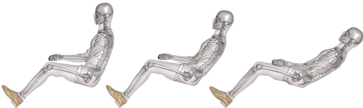
Figure 24: Modèle GHBMCM50-O positionné pour diverses inclinaisons de dossier. De gauche à droite : dossier incliné à 22, 40, et 60 degrés.
