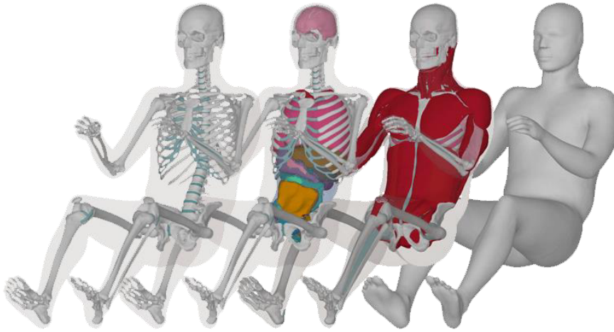
Figure 23: Modèle GHBMCM50-O (Source : www.elemance.com ) De gauche à droite : squelette, organes, muscles et peau du modèle
