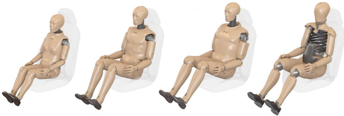
Figure 22: Mannequins de choc utilisés pour les collisions frontales (Source : humanetics.humaneticsgroup.com ) De gauche à droite : Hybrid III 5th Female, Hybrid III 50th Male, Hybrid III 95th Male, THOR-50M
