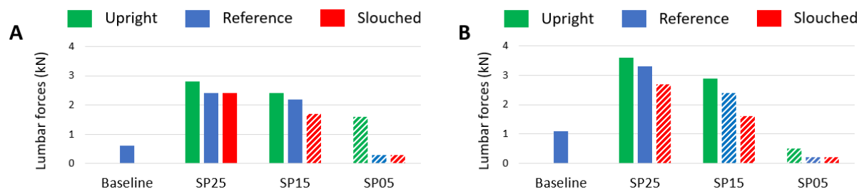
Figure 74 : Efforts lombaires observés pour les configurations de siège incliné. Les barres pleines et hachurées représentent respectivement les configurations où le sous-marinage n'a pas eu lieu, et où il a eu lieu. A : Pulse #1, B : Pulse #2
