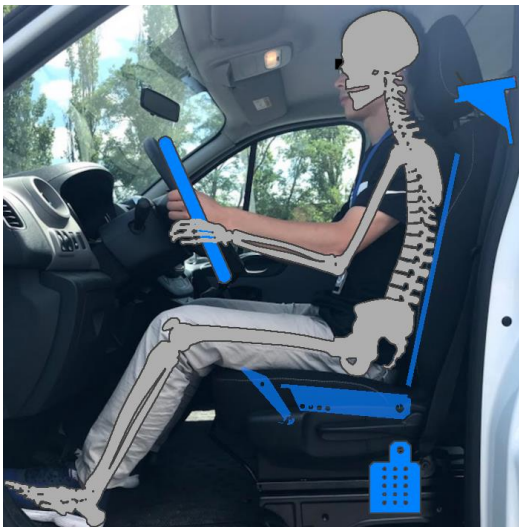
Figure 54 : Estimation de la posture d'un occupant dans un Renault Trafic. Le squelette et l'environnement du modèle VAN driver sont également représentés.
