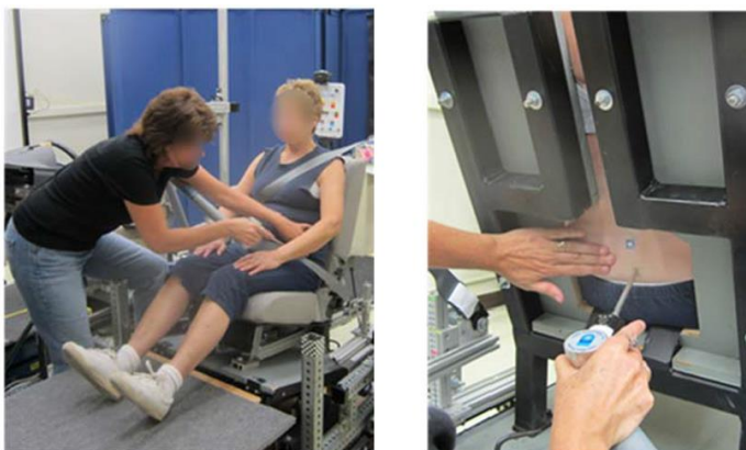
Figure 12 : Quantification posturale via identification de points anatomiques externes en utilisant un bras de mesure FAROArm (Park et al. 2016). La figure illustre la palpation de points anatomiques externes du bassin.
