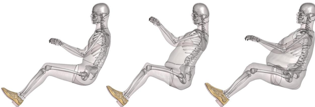
Figure 25: Modèle GHBMCM50-O modifié afin de représenter des occupants obèses (Janak, 2020). De gauche à droite : IMC de 25.7 (modèle initial), 34.7, et 43.7 kg/m 2 .
