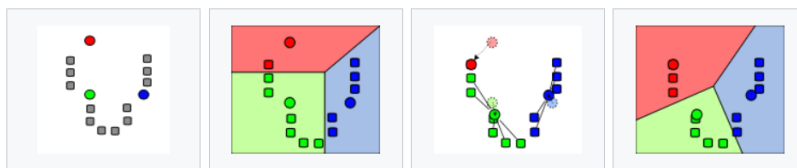
FIGURE 2.2 – Illustration de l’algorithme K-means pour k = 3 groupes. On commence avec 3 points choisis au hasard comme ”centres” (a). On obtient ainsi 3 premiers groupes (b). Puis le centre de chacun de ces groupes est re-calculé (c) suivi par la composition des groupes (d). Cette itération continue jusqu’à convergence.
