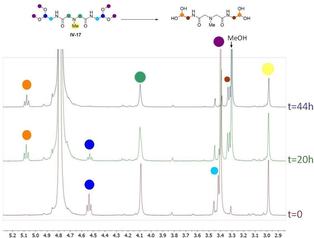
**Figure 75** : Spectre RMN partiel (300MHz, D<sub>2</sub>O, 298 K) du suivi de la déprotection de l'aldéhyde *N*-méthyliminodiacétique en milieu acide
