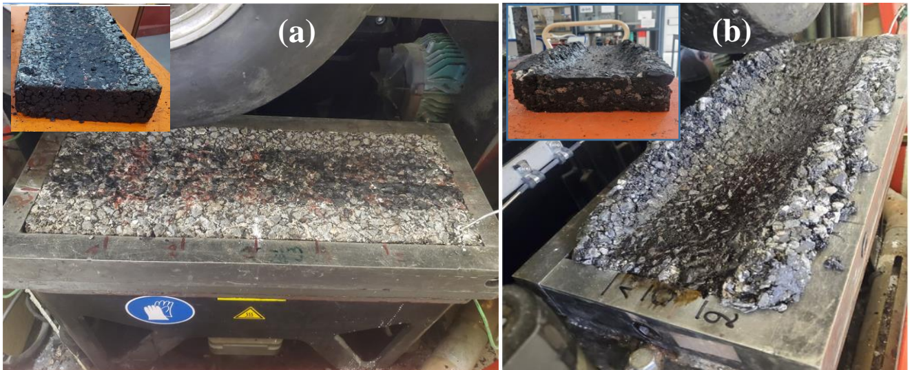
Figure V-12 : Plaques d'enrobés à l'émulsion avec le filler (a) PGP-LHF et (b) calcaire après l'essai d'orniérage.
