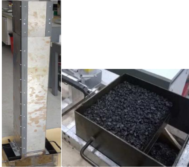
Figure II-23 : Moule et goulotte utilisés.
