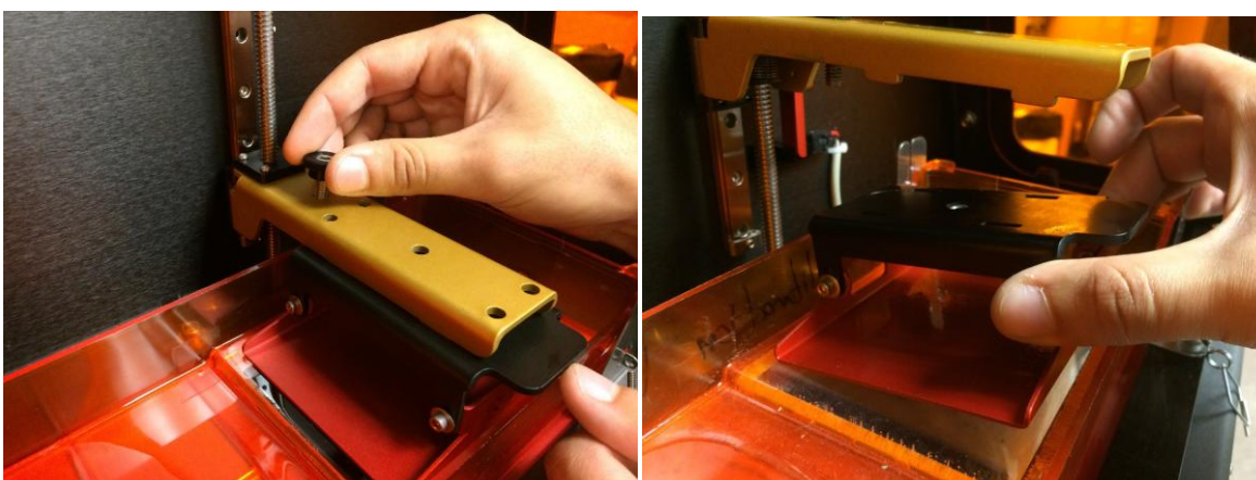
Figure 9 : Retrait de la vis reliant la table de construction au bras (gauche) puis détachement de la table de construction du silicone (droite)
