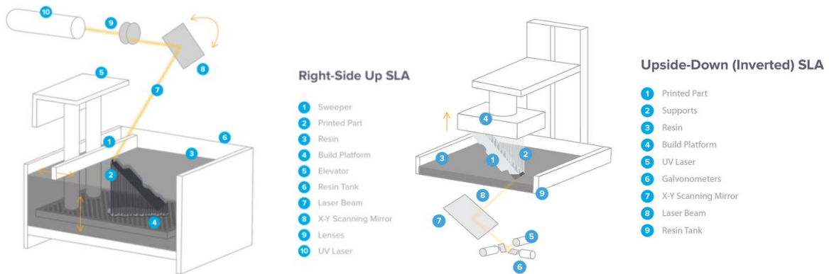
Figure 31 : Comparaison des approches Top-Down (gauche) et Bottom-Up (droite) en DLP [58]
