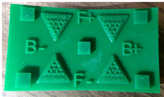
Figure 15 : Exemple de pièce de calibration imprimée avec la résine commerciale "Emerald"
