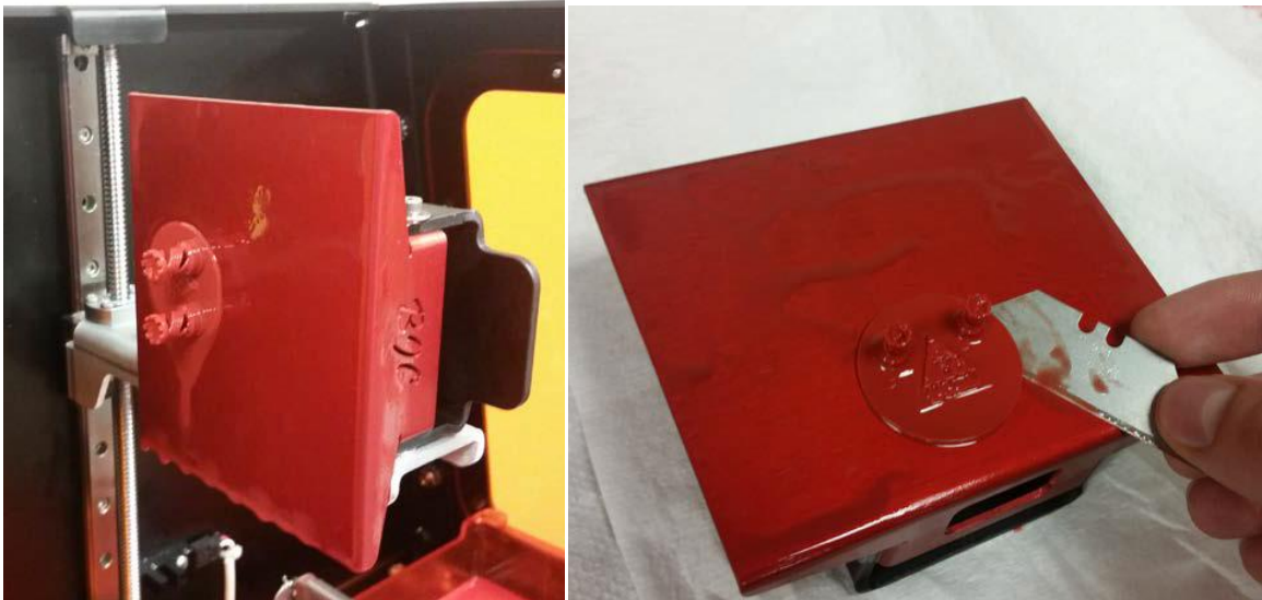
Figure 14 : Drainage de la résine sur la table de construction après impression (gauche) et détachement de la pièce fabriquée de la table de construction (droite)
