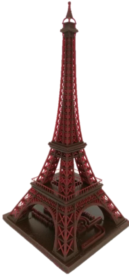
Figure 23 : Modèle complexe de Tour Eiffel imprimé avec le système étudié à l'aide d'une imprimante 3D DLP B9Creator
