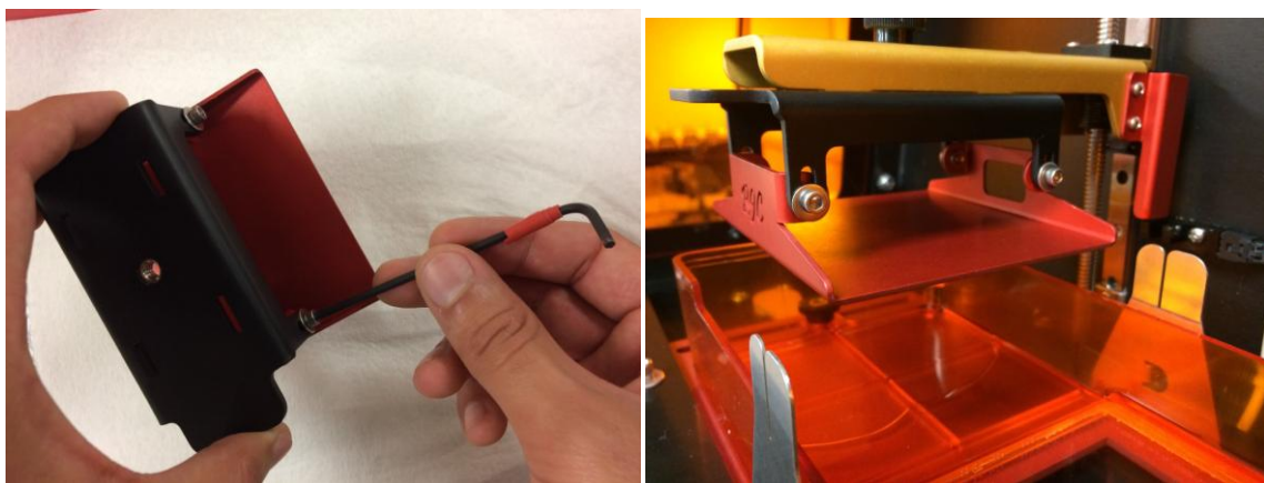
Figure 7 : Desserrage des vis hexagonales (gauche) et installation de la table de construction (droite)
