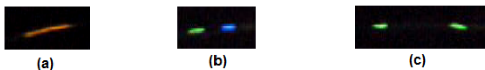
FIGURE 1.6 – Type de marquage : (a) marque de type unique ; (b) deux marques séparées d’une distance courte ; (c) deux marques séparées d’une distance longue.
