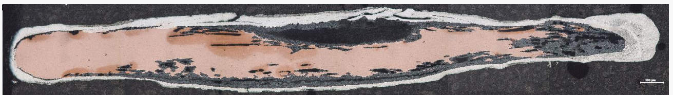
Figure 37. Section polie d'un victoriat plaqué (jc2, [cat. 15]), observée par microscope optique (5x). D'après CORSI 2015, p. 46.
