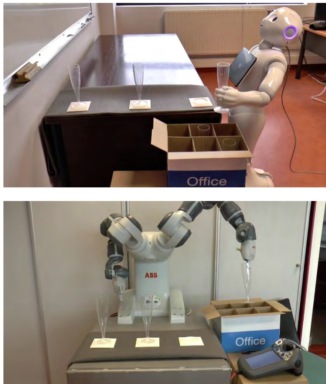
Figure 37 : Image de la vidéo de la tâche à réaliser lors l'expérience principale En haut avec le robot Pepper et en bas avec le robot YuMi
