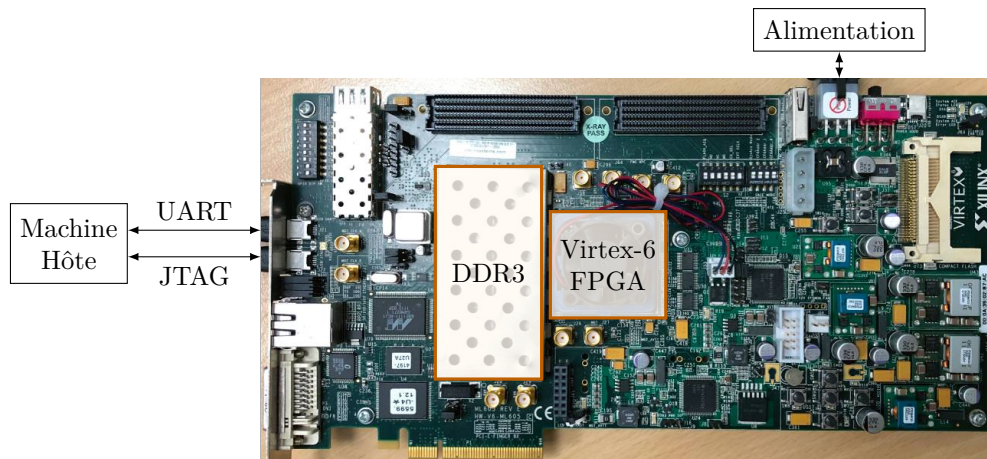
FIGURE 4.1 – Plateforme d'expérimentation composée d'une carte d'évaluation ML605 et d'une machine hôte.
