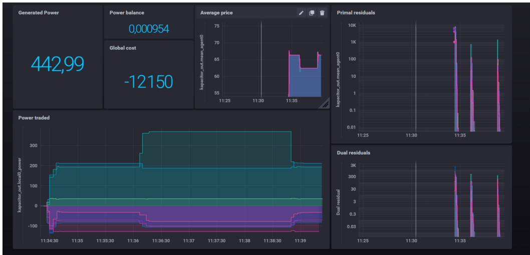
FIGURE 3.26 – Capture d'écran de la fenêtre Chronograf, paramétrée pour afficher les valeurs de l'avancement global de l'algorithme en fonction du temps : la puissance de chaque agent, les variables duales "price", le coût global, ainsi que les différents résidus de l'algorithme ADMM. Dans cette capture, la fonction coût d'un des agents a été modifiée pendant la résolution, avant d'être rétablie à sa valeur initiale. On observe que le marché s'adapte rapidement à ce changement.
