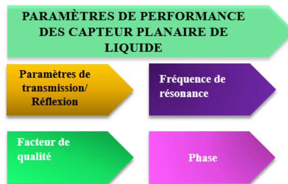
Figure I.18: Schéma descriptif des paramètres de performance des Capteurs planaires
