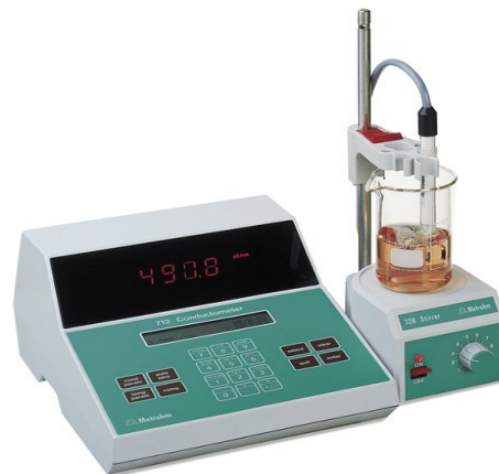
Figure I.6: Méthode de mesure par conductimétrie
