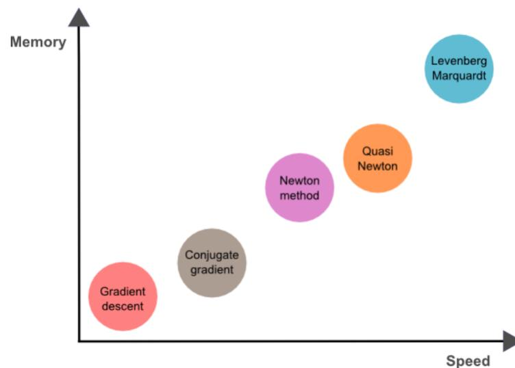
Figure 6.14 – Comparer les performances des algorithmes d'apprentissage
