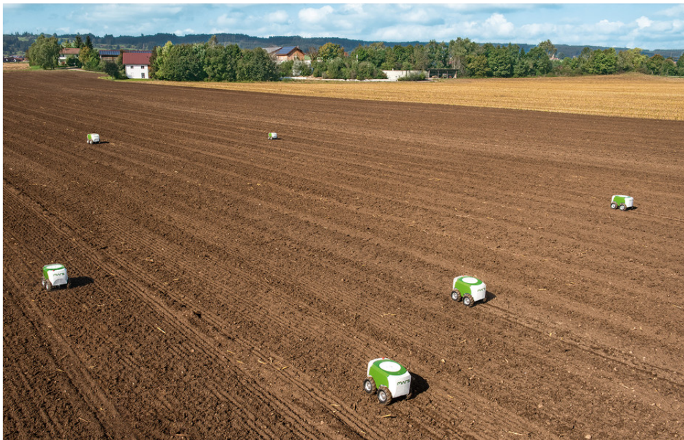
Figure 2.15 – Un nouveau système Xaver de Fendt utilise des essaims de robots pour la plantation du maïs
