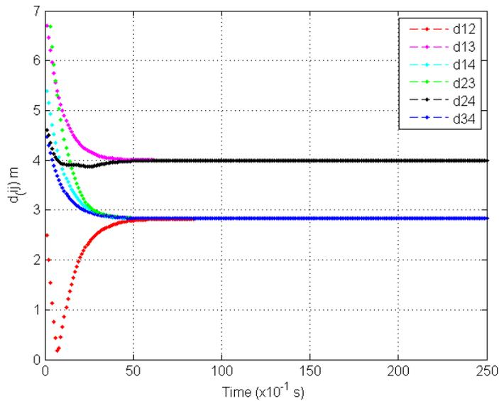
Figure 5.7 – Distances entre les robots sans l’évitement des collisions. (Nous pouvons voir que la distance entre les robots 1 et 2 ( $d_{12}$ ) est inférieure à 1m. Cela conduit à une collision entre ces deux robots. La valeur 1m a été définie en tenant compte de la taille des robots.)
