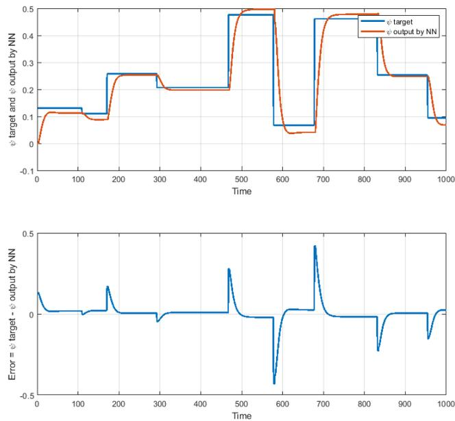
Figure 6.12 – Contrôle en  $\psi$  avec 40 neurones
