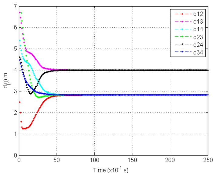
Figure 5.8 – Distances entre les robots avec évitement des collisions. (Dans ce cas, nous pouvons voir que la distance entre les robots  $d_{ij}$  est toujours supérieure à 1. Cela garantit l'absence de collision entre les robots.)
