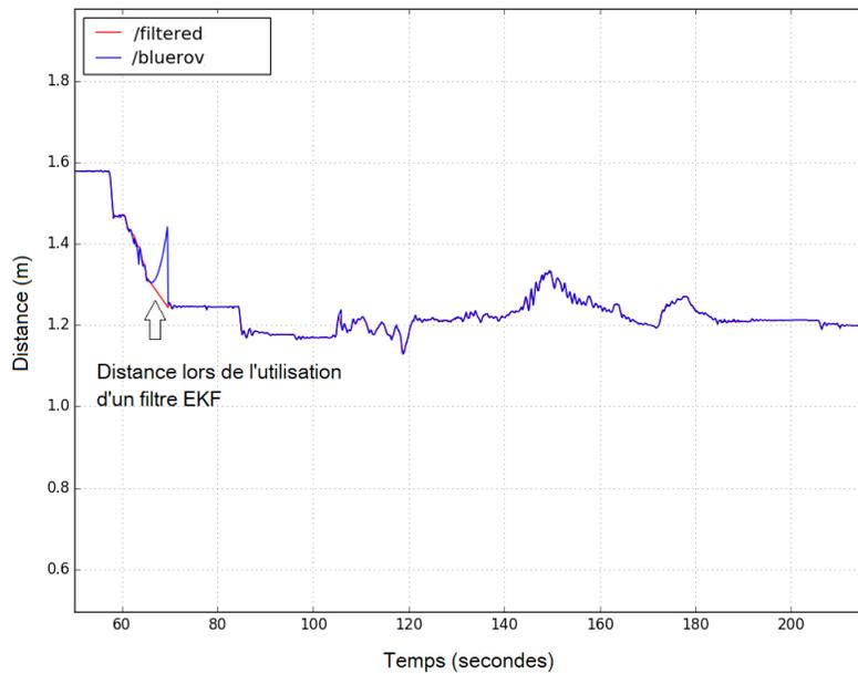
**Figure 7.7 – Distance entre robot BlueROV suiveur-2 et robot BlueROV leader.** (La ligne rouge indique la valeur de la distance entre le suiveur du robot et le leader du robot après avoir utilisé le filtre EKF pour combiner les valeurs de vision et d'IMU. La ligne bleue montre les valeurs de distance entre deux robots lorsque le filtre EKF n'est pas utilisé.)
