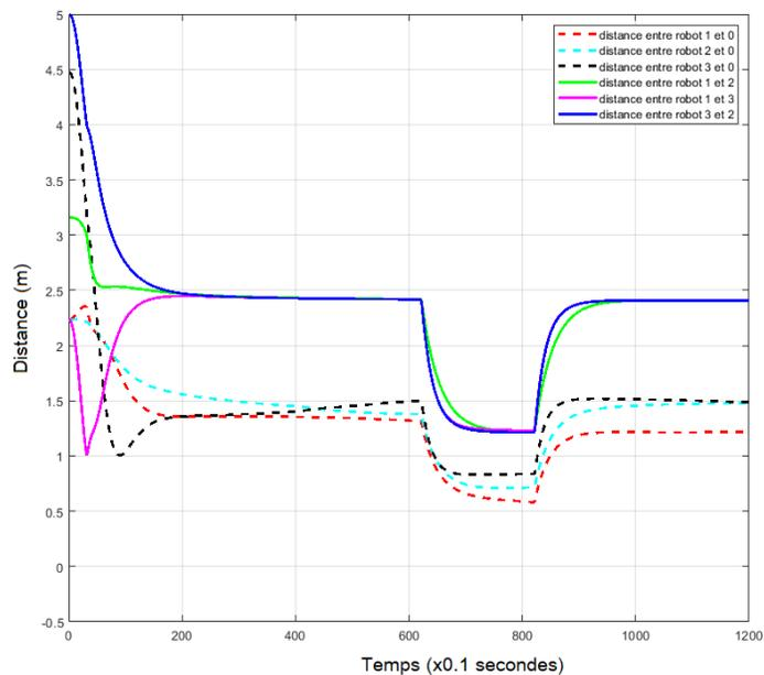
**Figure 6.19** – Les distances entre 3 robots dans cas 1. (La ligne continue montre la distance entre 3 robots sous-marins. La ligne en pointillés montre la distance entre les 3 robots sous-marins et le robot leader virtuel.)
