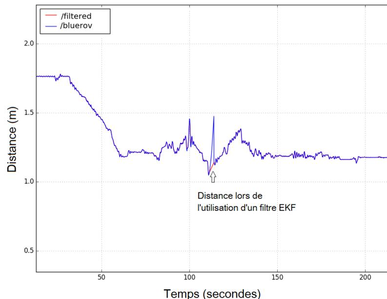
**Figure 7.6 – Distance entre robot BlueROV suiveur-1 et robot BlueROV leader.** (La ligne rouge indique la valeur de la distance entre le suiveur du robot et le leader du robot après avoir utilisé le filtre EKF pour combiner les valeurs de vision et d'IMU. La ligne bleue montre les valeurs de distance entre deux robots lorsque le filtre EKF n'est pas utilisé.)
