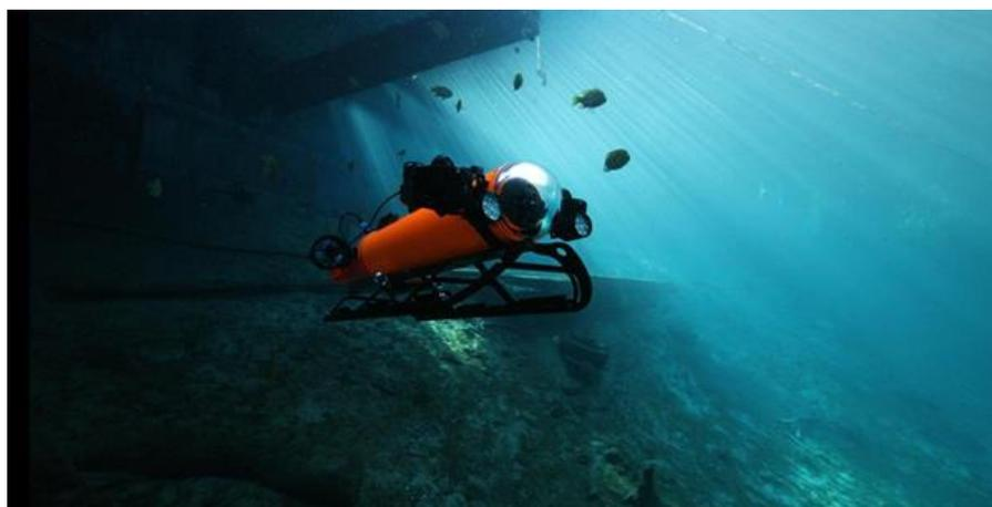
Figure 2.10 – Aquabotix hybride AUV-ROV
