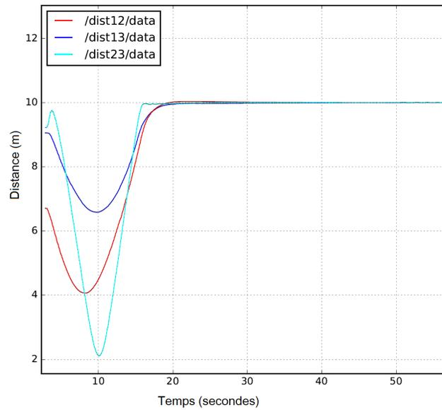
Figure 6.35 – Distances entre trois robots sous-marins sans terme d'évitement de collision. ( $/dist_{ij}/data$  signifie la distance entre le robot  $i$  et  $j$ )
