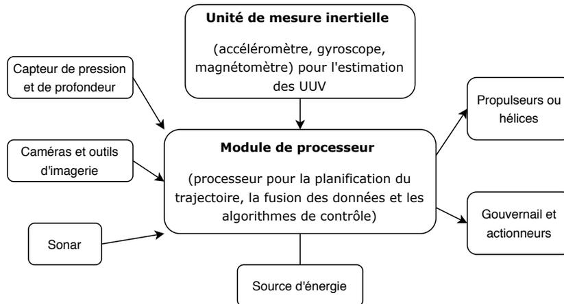
Figure 2.6 – Architecture générale des composants d'un UUV
