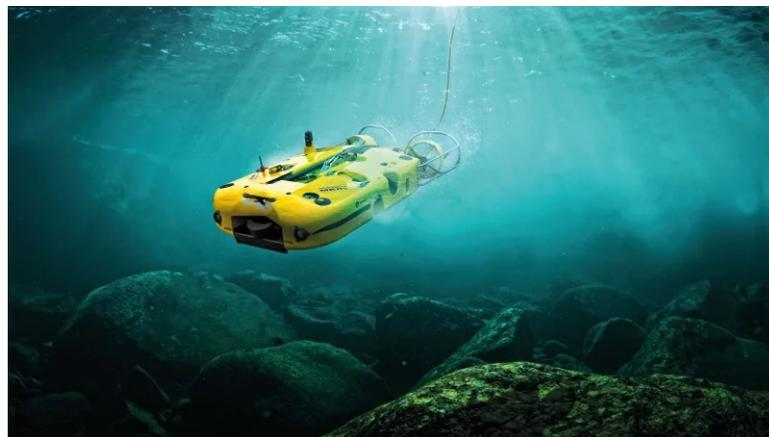
Figure 2.12 – Un véhicule hybride sous-marin Double Eagle (Photo : Saab)
