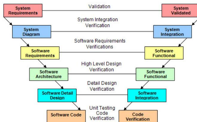
Figure 2.2 – Modèle V (Photo de ProductiveHut.com)
