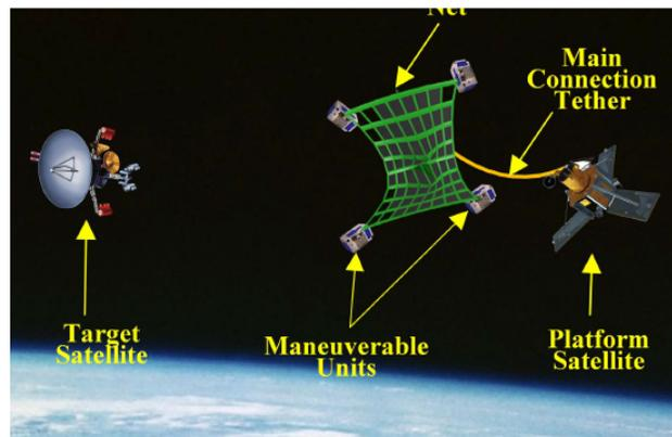
Figure 2.20 – Robot à filet spatial attaché (Photo : [92])
