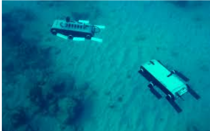
Figure 2.17 – Convoyage sous-marin multi-robots utilisant le suivi visuel par détection (Photo de [49])
