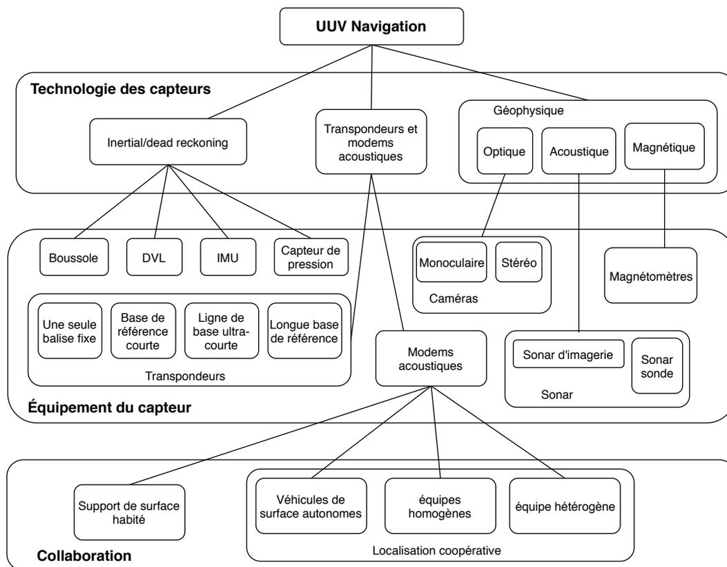
Figure 2.13 – Navigation et localisation d'UUV (selon l'article [47])
