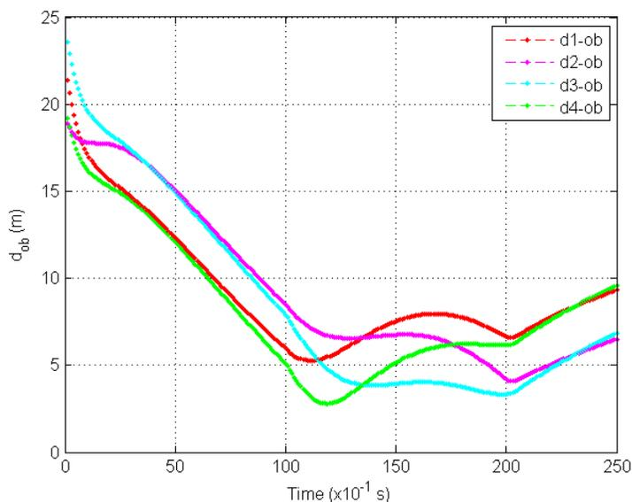
Figure 5.9 – Distances entre les robots et l'obstacle. (En supposant que la position de l'obstacle est donnée, on constate que la distance entre les robots et l'obstacle ( $d_{i-ob}$ ) est toujours supérieure à 2m (la valeur est prédéfinie et peut être ajustée). Cela garantit qu'il n'y a pas de collision entre les robots et les obstacles.)
