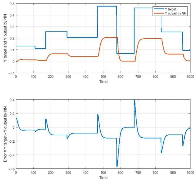
Figure 6.11 – Contrôle en  $y$  avec 40 neurones
