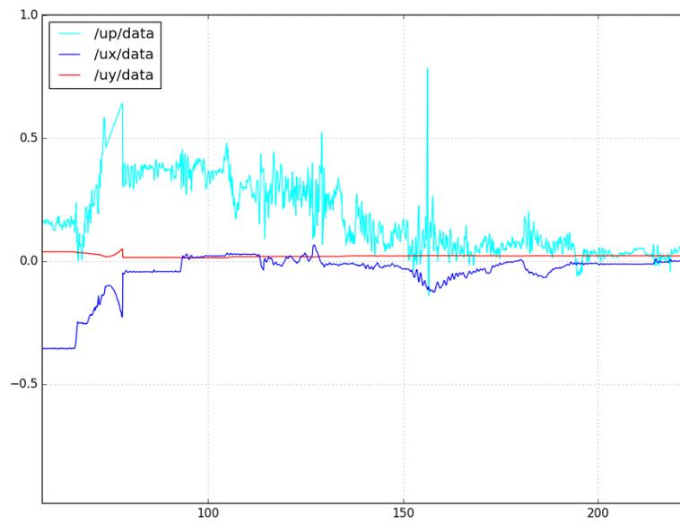
Figure 7.9 – Signaux de commande selon 3 axes du robot BlueROV suiveur-2. (Une ligne bleue, rouge et bleu ciel représente un signal de commande sur l'axe des  $x$ ; axe  $y$  et signal de commande d'angle correspondant.)
