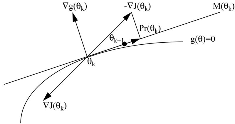
Figure A.1 – Méthode de projection de gradient
