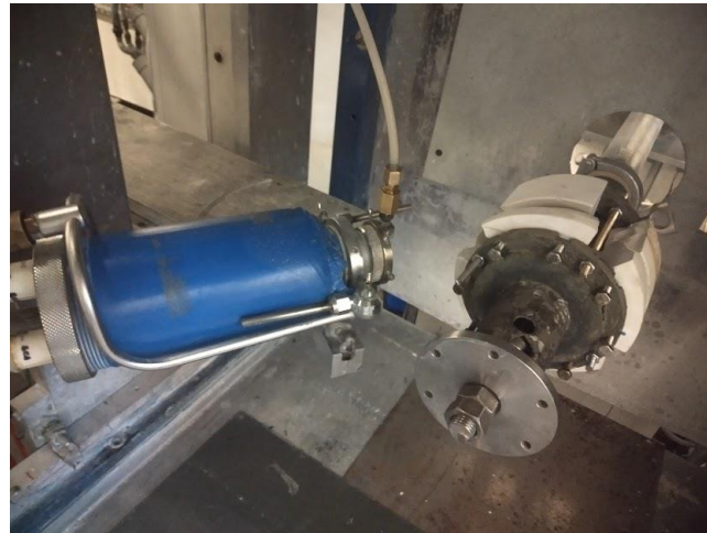
Figure II-31. Essai préliminaire de scellement par projection thermique de pièces cylindriques.
