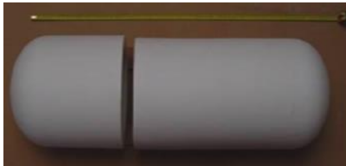
Figure I-3. Prototype d'un surconteneur en céramique [1].
