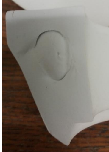
Figure II-10. Partie supérieure de l'assemblage présentant un défaut de fabrication initiale – essai 33-10-500.
