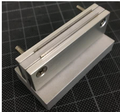
Figure II. 12: Gabarit avec lames de rasoir utilisé pour la découpe d'éprouvettes de traction.
