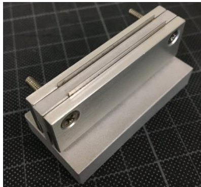
Figure II. 12: Gabarit avec lames de rasoir utilisé pour la découpe d'éprouvettes de traction.
