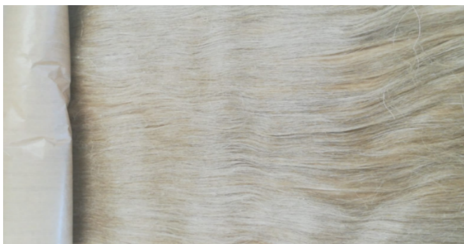
FIG. 2.1 – Rouleau de faisceau de fibres de lin d'où sont extraits les échantillons de faisceaux de fibres.
