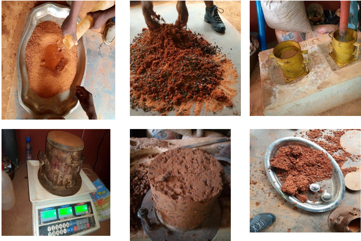
Figure 26 : Quelques étapes pour les essais Proctor Modifié sur la terre de barre et les mélanges CNP /TB
