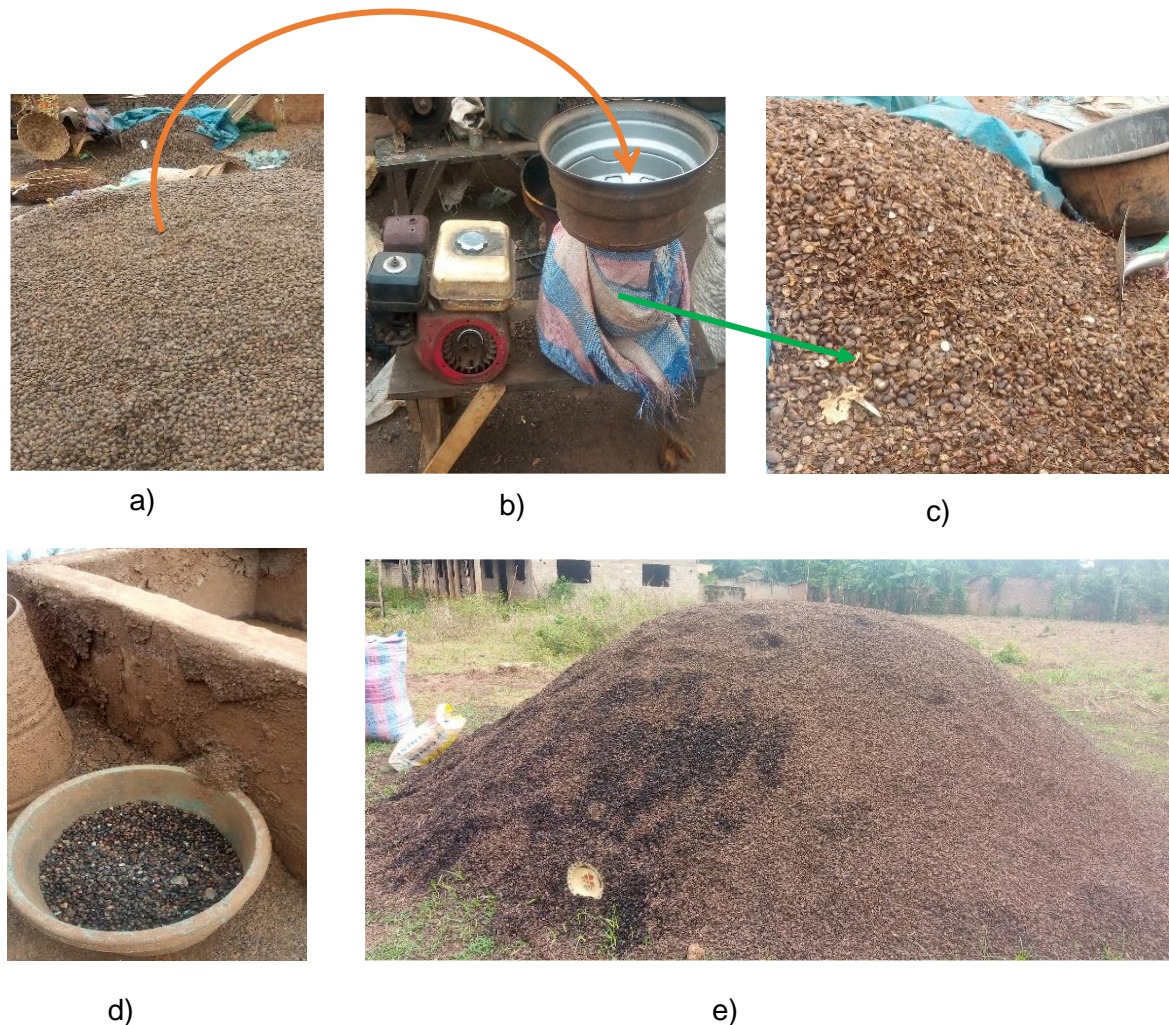
Figure 10 : obtention artisanale des CNP : a) Noix de palmiste b) machine artisanale de concassage des noix c) mélange amande + coque + fibres, d) séparation dans l'eau coque et amande par le principe de différence de densité, e) tas de CNP, prêtes pour le prélèvement en vue des essais de laboratoire.
