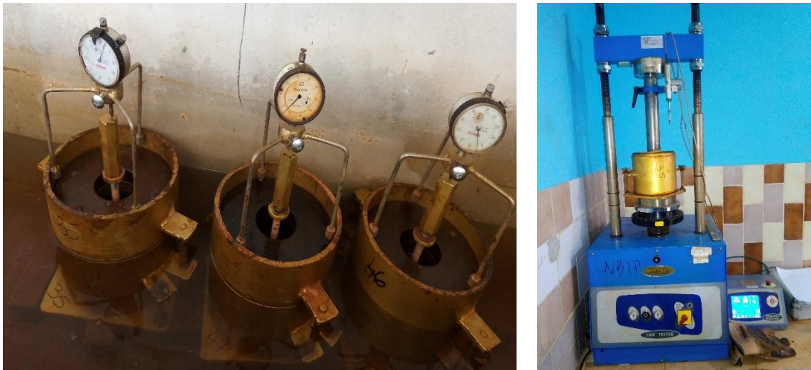
Figure 27 : a) conservation des échantillons compactés à la teneur en eau optimale b) dispositif de poinçonnement pour l'essai CBR
