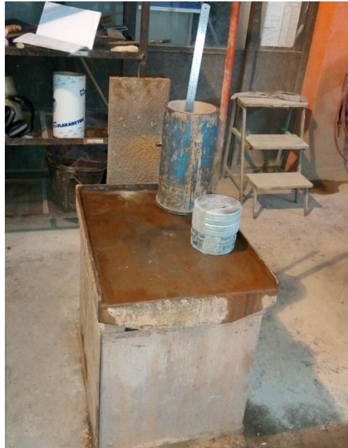
Figure 51 : Processus de détermination de la compacité expérimentale
