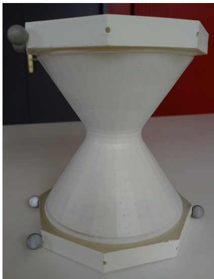
FIGURE 5.10 – SABLIER équipé des chapeaux permettant d'être suivi par un système infrarouge type OptiTrack.
