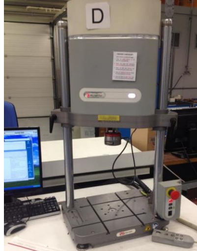
Figure 2.12 : Presse Instron® E1000 utilisée pour les mesures électrochimiques avec force de serrage.
