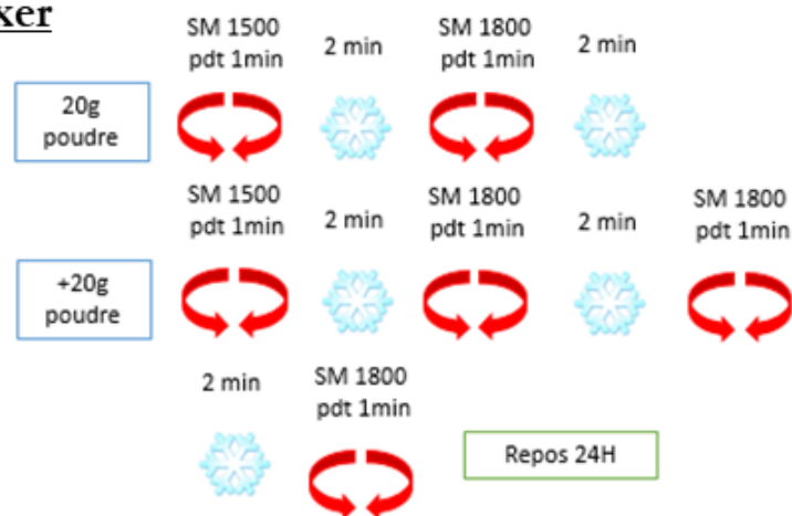
FIGURE 3.3 – Mélange des composants d'une encre céramique entre 38 et 44% volumique de phase sèche
