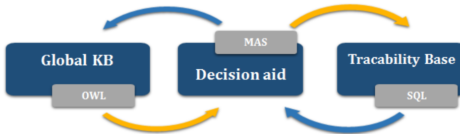
Figure 52. Répartition des bases et communication avec le SAD.
