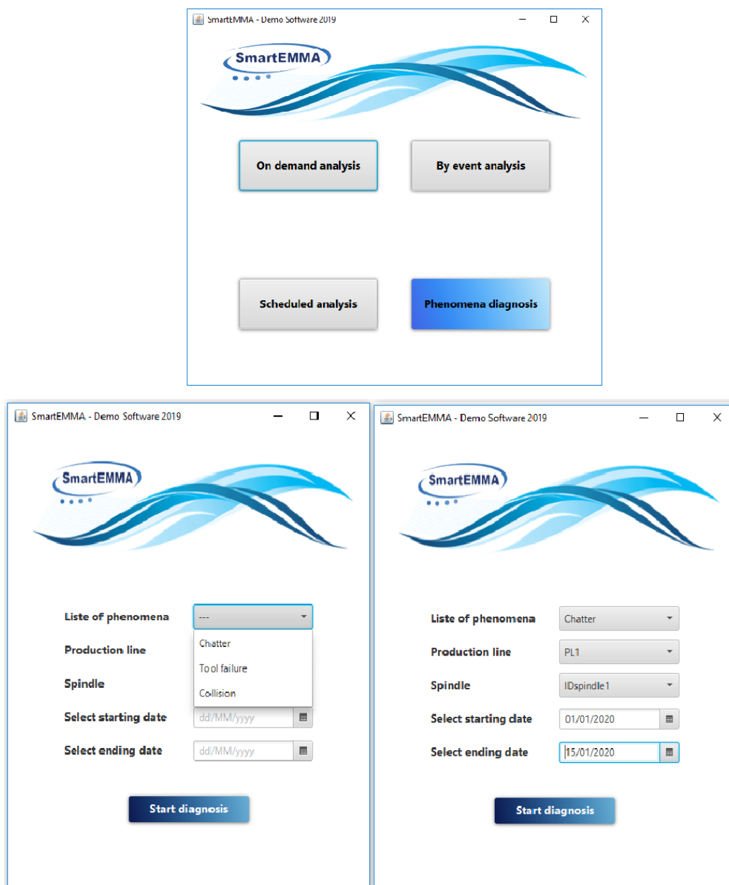
Figure 63. Interface utilisateur pour la configuration de l'opération de diagnostic
