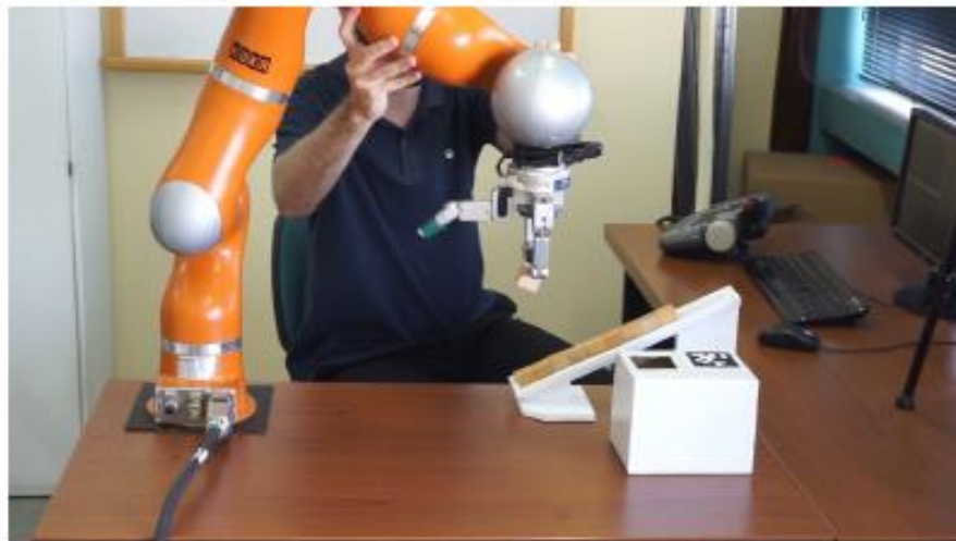
Figure 21 Programmation par démonstration d'un robot pour une opération de PAP (Dimeas et al., 2019)
