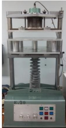
Figure 5-3 - Photographie du compressomètre E-29 Buchel-Van Der Korput
