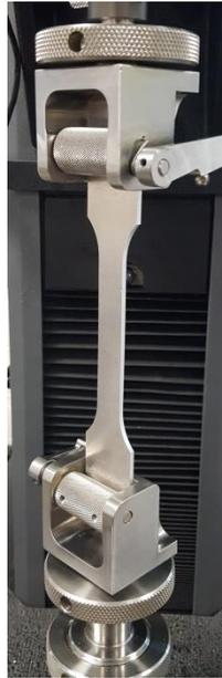
Figure 3-20 - Mors excentrés utilisé lors des essais de traction
