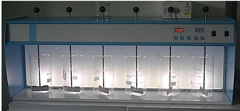
Figure 3-11 - Photographie de l'appareil Jar Test
