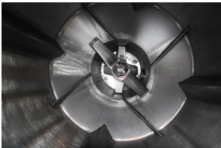
Figure 3-10 - Photographie de l'intérieur du pulpeur Noviprofibre utilisé
