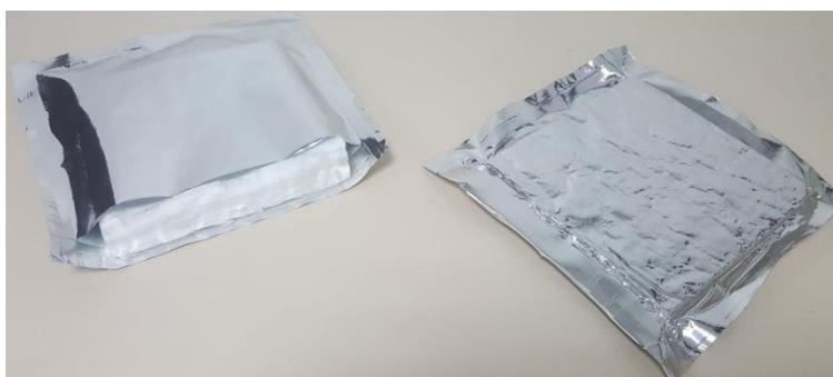
Figure 1-2 - Vue d'un VIP ouvert (à gauche) et fermé par thermoscellage (à droite)
