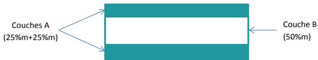
Figure 4-23 - Schématisation d'un matelas en structure sandwich
