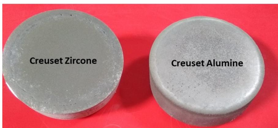
FIGURE 4.14 – Surface des échantillons solidifiés dans les conditions de température de l'atomisation pour l'étude de l'influence du creuset.
