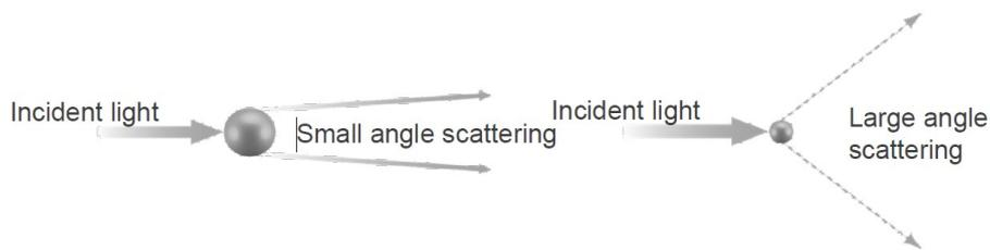
FIGURE 3.3 – Principe de la diffraction laser pour la mesure de la taille d’une particule sphérique [66].
