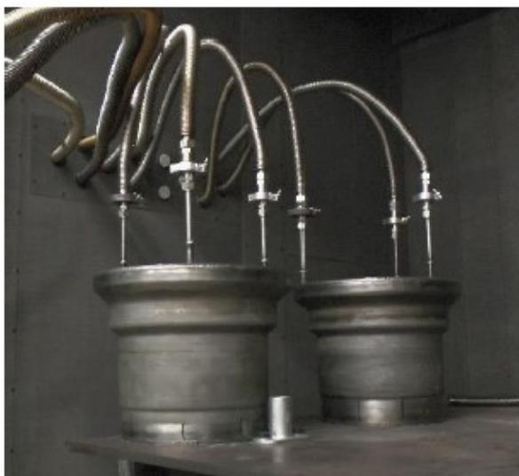
FIGURE 2.16 – Conteneur avec tubes reliés aux systèmes de remplissage et de dégazage [10].
