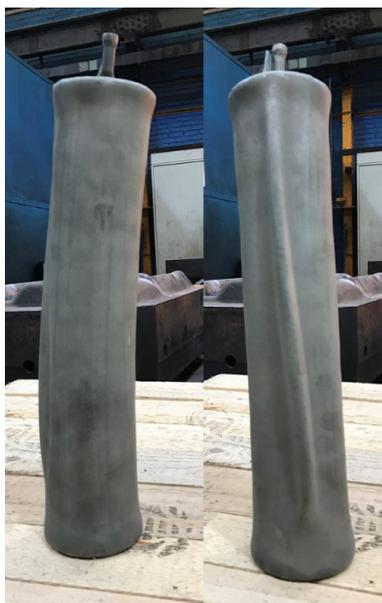
FIGURE 6.1 – Déformation non contrôlée d'un conteneur lors du cycle de compaction due à une densité non homogène au remplissage.
