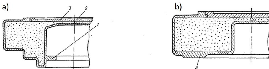
FIGURE 2.13 – a) Conteneur avec raidisseur : 1) Raidisseur ; 2) Membrane ; 3) Couverture. b) Raidisseur en fond de conteneur A) raidisseur [29].
