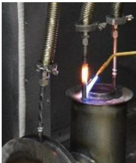
FIGURE 2.18 – Chauffage des tubes de tirage au vide avant Queusotage [10].
