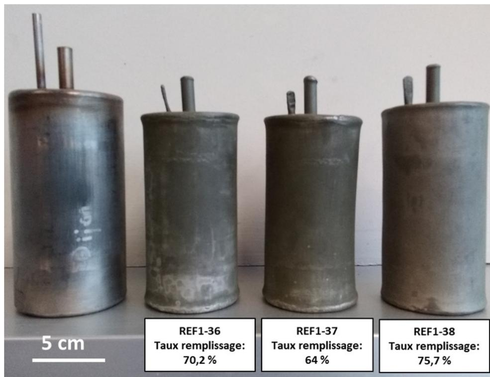
FIGURE 6.11 – Comparaison visuelle des déformées des conteneurs de mélanges de poudre après CIC. Un conteneur avant CIC (sans couche de chromine) est présenté à gauche.
