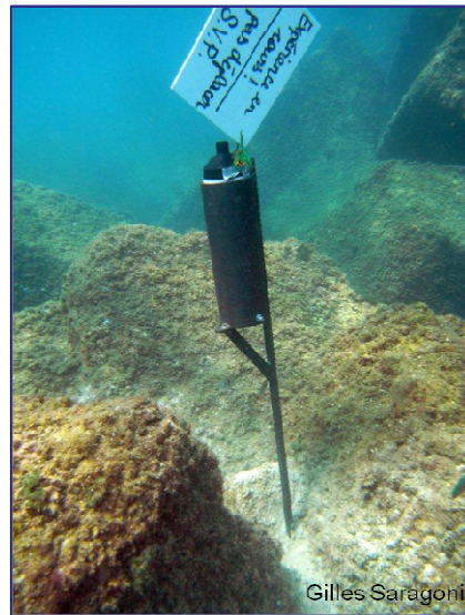
Figure 1-26. Système de fixation de type torche pour les récepteurs acoustiques déployés dans les zones peu profondes comme les digues et les éboulis rocheux.
