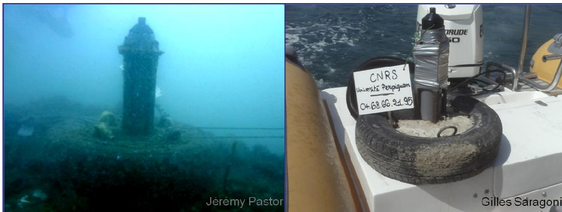
**Figure 1-27. Système de fixation type corps morts pour les récepteurs acoustiques dans les zones rocheuses plus profondes.**
