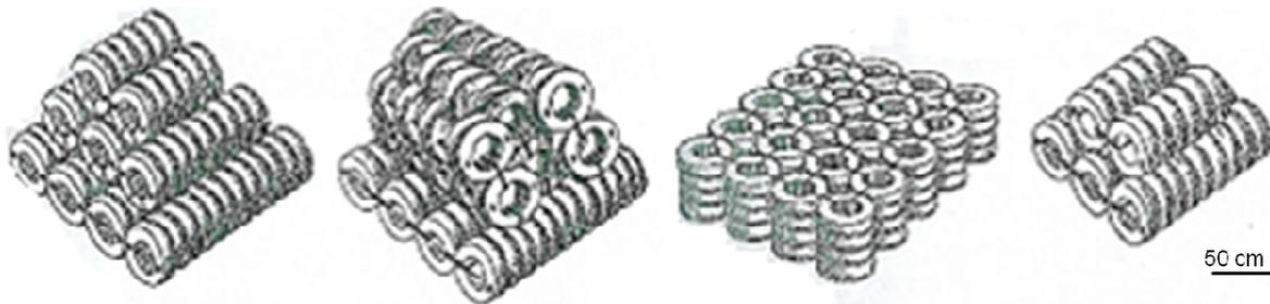
**Figure 3. Récifs artificiels constitués de différents assemblages de pneus de voitures, dont certains coulés dans du béton (Spanier et al. 1990).**
