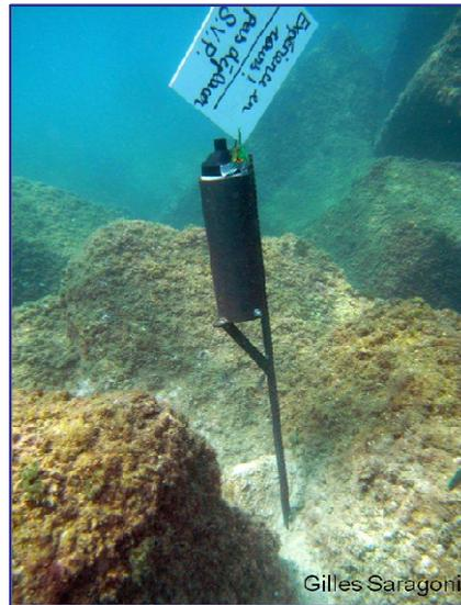
**Figure 1-26. Système de fixation de type torche pour les récepteurs acoustiques déployés dans les zones peu profondes comme les digues et les éboulis rocheux.**
