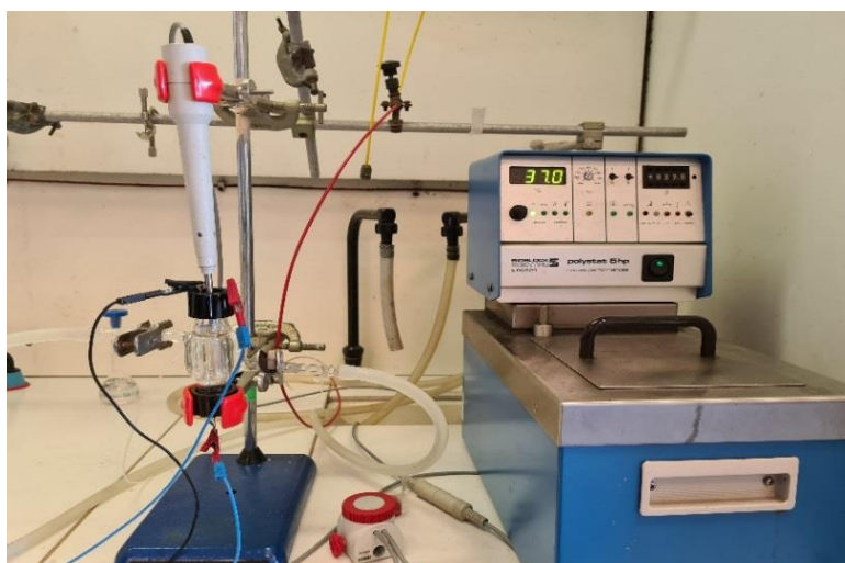
Figure I-22 : Schéma du montage électrochimique utilisé pour la voltammétrie cyclique ou la chronoampérométrie.
