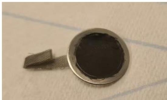
*Figure B-1 : Exemple de d'une électrode modifiée avec les nanohybrides.*
