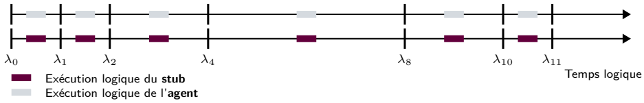
Figure 6.3 – Schéma d'exécution en temps logique d'un agent et d'un stub. Les tics \lambda_{i|i \in \mathbb{N}} d'une horloge logique contraignent leur cadencement.
