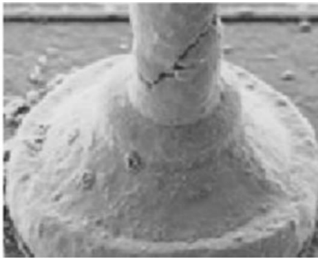
Figure 1.4 : Connexion défaillante par fissuration de la broche
