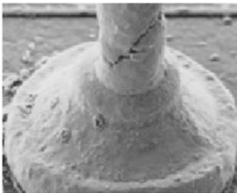
Figure 1.4 : Connexion défaillante par fissuration de la broche
