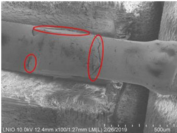
Figure 3.4 : Observation soudure numéro 1 (Gauche : vue de haut, Droite : vue de coté)
