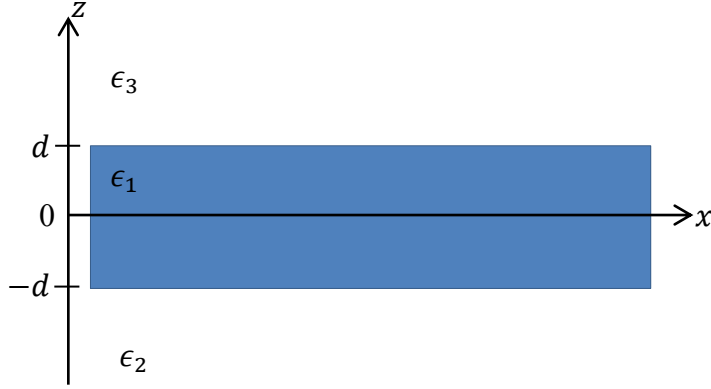
Figure 1.8 : Géométrie d'un système à trois couches.
