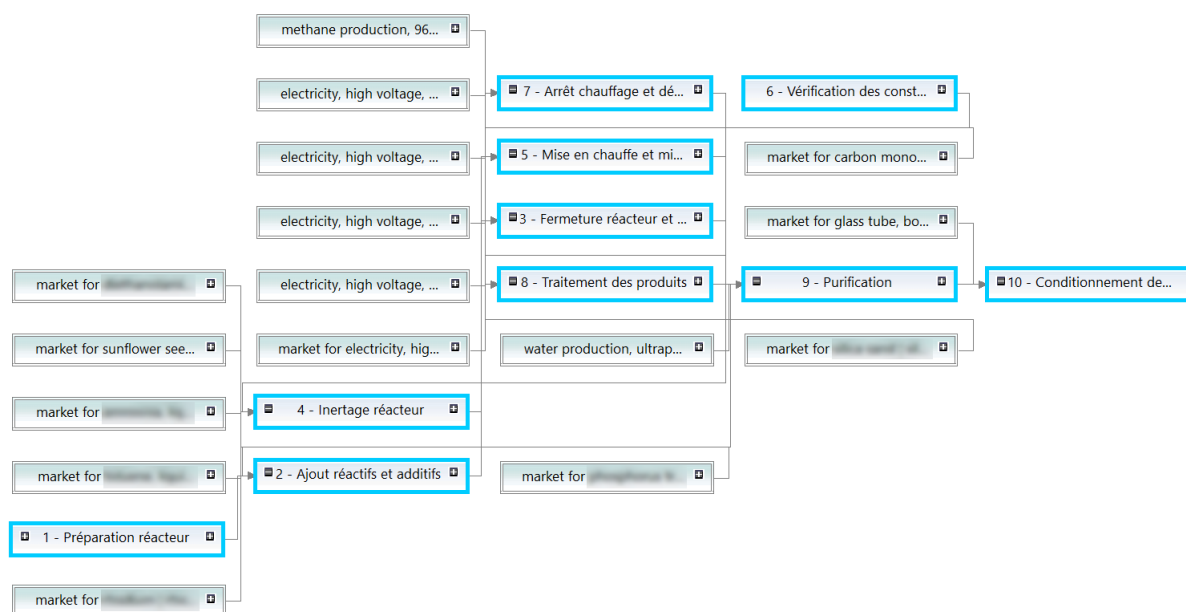
Figure 5-7. Modélisation du procédé de production de polyamine dans openLCA
