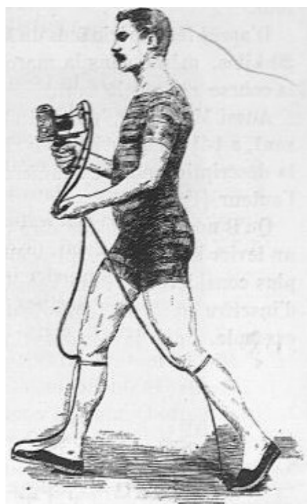
Figure 8. 3 Une personne munie des chaussures exploratrices et portant le chronographe de Marey. Un tube de transmission fait communiquer la chambre à air placée au-dessous des chaussures avec le tambour à levier du chronographe [14].
