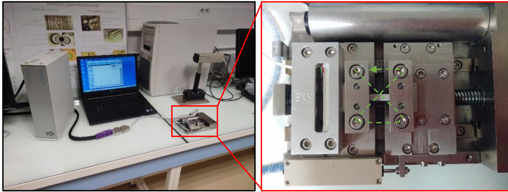
Figure III. 8 : Dispositif expérimental de l'essai de traction a) vue globale, b) vue détaillée d'un échantillon positionné dans la micro-machine de traction.
