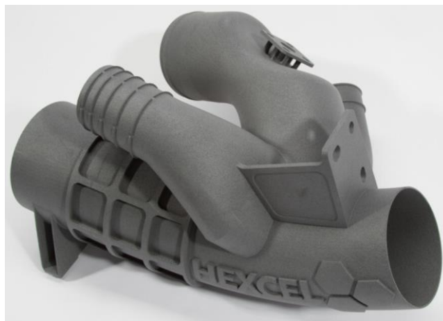
Figure 1-6. Conduits HEXCEL imprimés à partir de PEKK et de fibres de carbones 7
